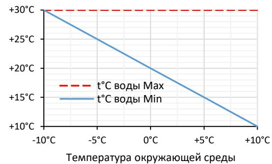
Раствор можно использовать в течение 1 часа с момента затворения водой. При повышении вязкости раствора в ёмкости (в пределах времени жизнеспособности) необходимо тщательно перемешать его без добавления воды.
